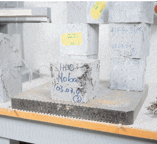
Bild 4: Im Vorfeld der Bauausführung wurden umfangreiche Untersuchungen zur Brandsicherheit und Druckfestigkeit der gewählten Rezeptur durchgeführt.
