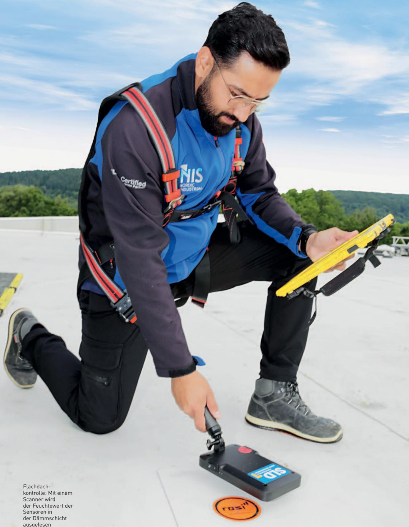
Flachdachkontrolle: Mit einem Scanner wird der Feuchtewert der Sensoren in der Dämmschicht ausgelesen
